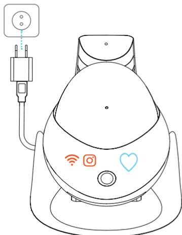
Роботты зарядтау қондырғысына қойыңыз. Егер индикаторлар жанбаса, «Қалпына келтіру» түймесін 5 секунд басып тұру арқылы роботты қалпына келтіріңіз, содан кейін «Қалпына келтіру» түймесін 2 секунд басып тұру арқылы роботты қосыңыз.
